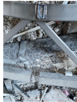
图 6、图 7 9 轴桁架下弦杆拼接焊缝处断裂位置，焊缝未焊满，接头不良
